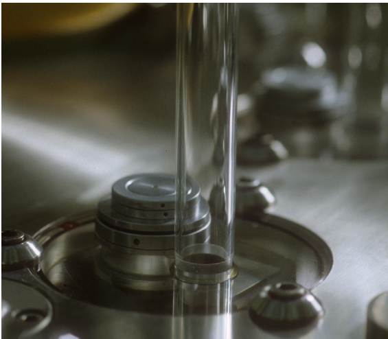
Abb. 5: Iscador-Herstellungsmaschine: Detailaufnahme eines der zwölf Einlässe für den Sommer-Misteextrakt am Rand des Deckels des Scheibenraumes.
