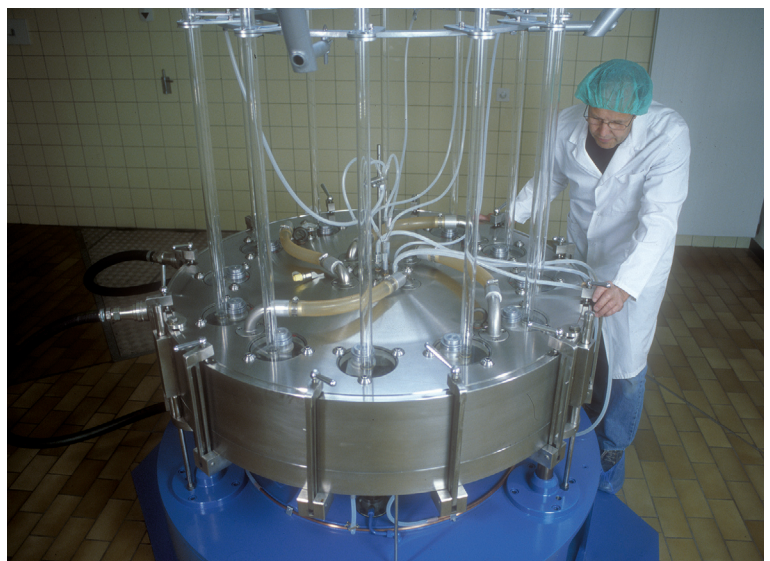
Abb. 2: Die für die Herstellung von Iscador eingesetzte Maschine. Sichtbar sind unten das Metallgehäuse, in welchem sich die drehende Scheibe (vgl. Abb. 3) befindet, sowie die zwölf Plexiglasrohre, in denen der Sommer-Mistelextrakt berührungsfrei in einzelnen Tropfen in den Scheibenrand fällt (Details in Abb. 4 & 5) und der eine zentrale Einlass für den Winter-Mistelextrakt (Details in Abb. 6).
